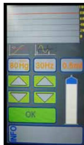
Abb.2: Druck-, Frequenz-, und Volumenmessung am Monitor
