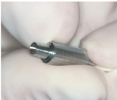
Abb. 5: Zurückziehen des rotierenden Messers
