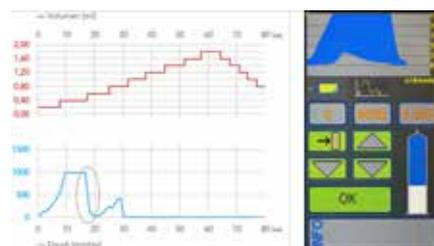
Abb. 16: Die JEDER-Pumpe® Druckkurve-Graphik (Links), Visuelles Feed-Back Display (Rechts)
